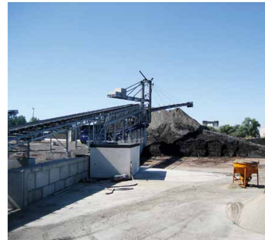
Aus Baggerschlämm entsteht ein gut handhabbares Material für den Deponiebau
