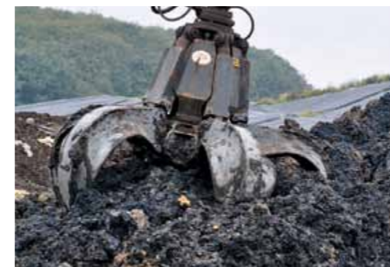
Aus Baggerschlämm entsteht ein gut handhabbares Material für den Deponiebau
