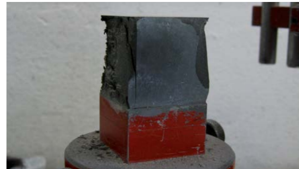
Abb. 7.13.1 Bruchbild sprödes Material - Druckfestigkeitsprüfung am Mörtelprisma
