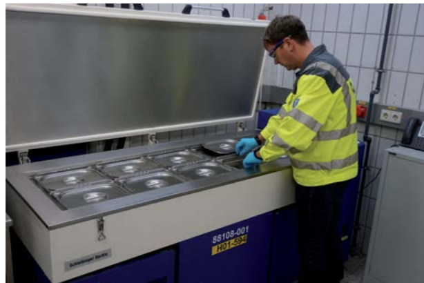
Abb. 3.2.4 (links) Messung des Frost- bzw. Frost-Tausalzwidestands mit der CDF-Truhe (Schleibinger)
