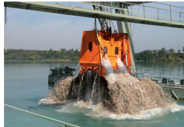
Abb. 1.3.2 Kies- und Sandgewinnung mit dem Schwimmgreifer
