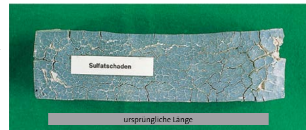
Abb. 10.6.1 Durch Sulfatangriff geschädigtes Zementmörtelprisma, Volumenvergrößerung (Treiben)
