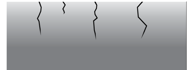
Abb. 10.3.8 Oberflächliche Risse als Folge des plastischen Schwindens
