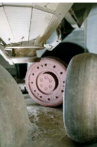
Abb. 1.1.3 Walzenschüsselmühle zum Feinmahlen des Rohgesteins
