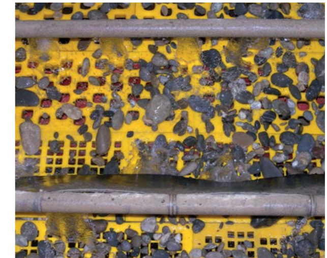
Abb. 1.3.16 Aussieben und Waschen von Gesteinskörnern in einem Kieswerk
