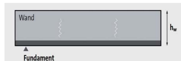
Abb. 8.13.9 Fundament verhindert Längsverformungen in der Wand
