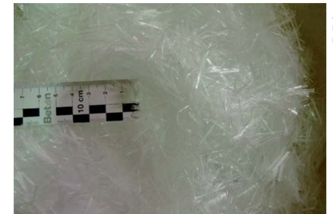
Abb. 8.16.12 Polypropylenfaser 20 mm Länge
