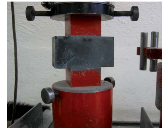
Abb. 1.1.21 Zementfestigkeiten am Mörtelprisma 40 x 40 x 160 mm
