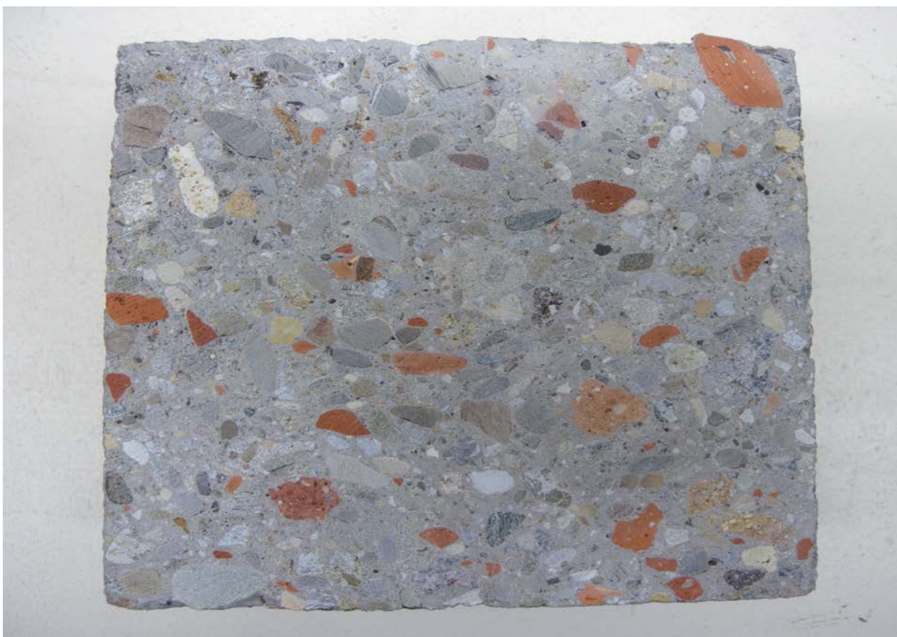
Abb. 3.5.3 R-Beton - Schnitt durch R-Beton-Würfel
