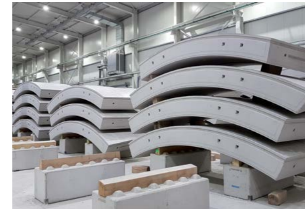
Abb. 8.7.3 Tübbinge nach der Herstellung in der Feldfabrik
