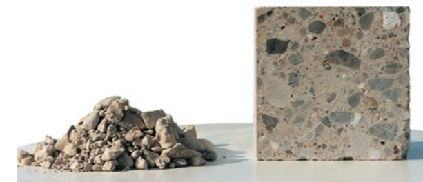
Abb. 7.15.2 Rezyklierte Gesteinskörnung und daraus hergestellter Konstruktionsbeton
