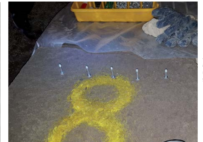
Abb. 7.10.13 (links) Messung der Frühfestigkeit mit der Penetrationsnadel nach wenigen Minuten
