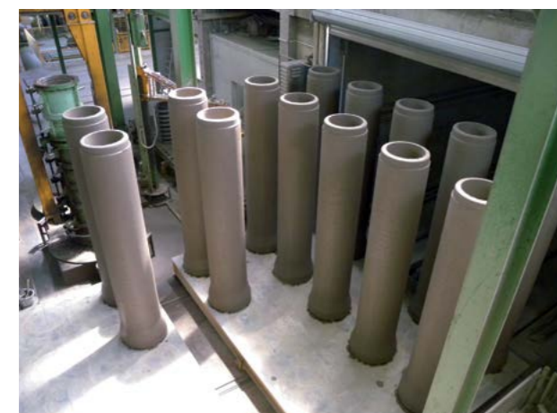
Abb. 9.2.2 Betonrohre direkt nach der Herstellung
