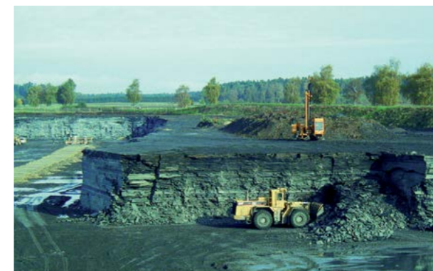
Abb. 1.1.11 Schieferabbau durch Sprengung
