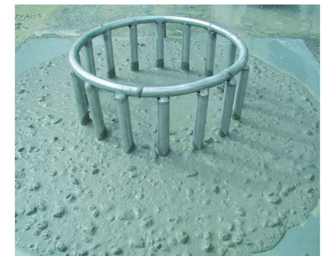
Abb. 3.8.8 (rechts) Setzmaß - Selbstverdichtender Beton, mit Blockiering
