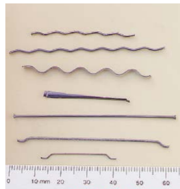
Abb. 1.7.2 (Links) Verschiedene Arten von Stahlfasern
