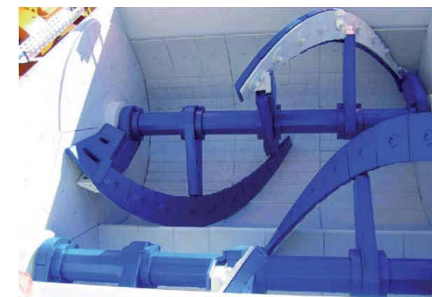
Abb. 4.1.4 Blick in einen Doppelwellenmischer
