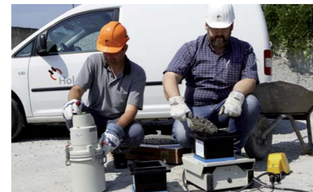
Abb. 8.4.10 Überprüfung der Luftporen und Würfelherstellung
