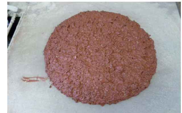
Abb. 7.7.4 Ausbreitmaß von Schwerbeton mit Hämatit
