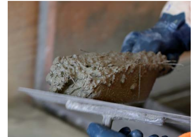
Abb. 7.8.2 Stahlfaserbeton bei der Probekörperherstellung
