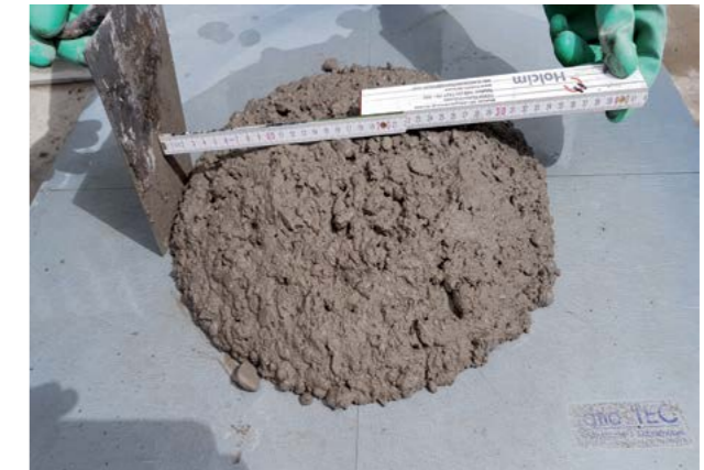
Abb. 5.3.4: Stark angesteifter Beton, infolge hoher Außentemperaturen
