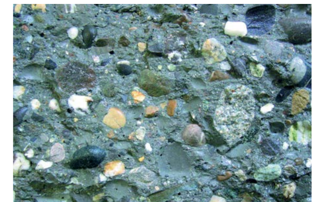
Abb. 7.9.3 (links) Bruchbild von Normalbeton. Beim Normalbeton (links) bricht zuerst der Zementstein.
