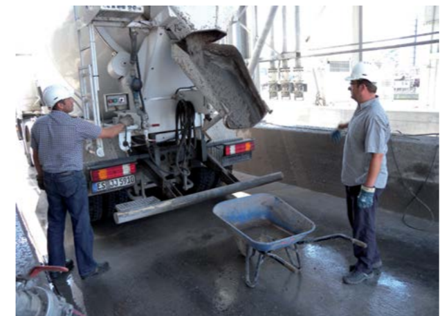
Abb. 6.4.2 Probenahme am Fahrermischer
