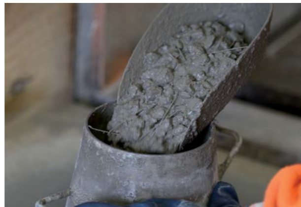
Abb. 8.16.8 Konsistenzprüfung bei Stahlfaserbeton
