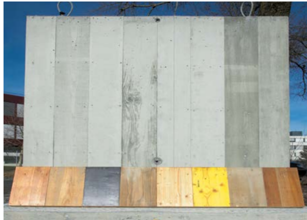
Abb. 8.3.14 Betonoberflächen mit unterschiedlichen Schalungshäuten
