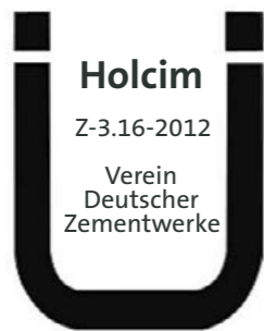
Abb. 1.1.28 Ü-Zeichen zum Konformitätsnachweis für einen Zement mit „Allgemeiner bauaufsichtlicher Zulassung“ z. B. Holcim Durabilo 4 N-SR (Schieferhochofenzement)
