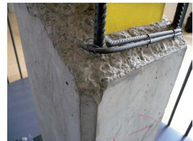
Abb. 3.4.5 Schnitt durch Betonstütze mit Sicht auf Bewehrungseinlage
