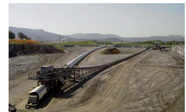
Abb. 1.6.8 Schieferbruch mit Brecher und Förderbändern
