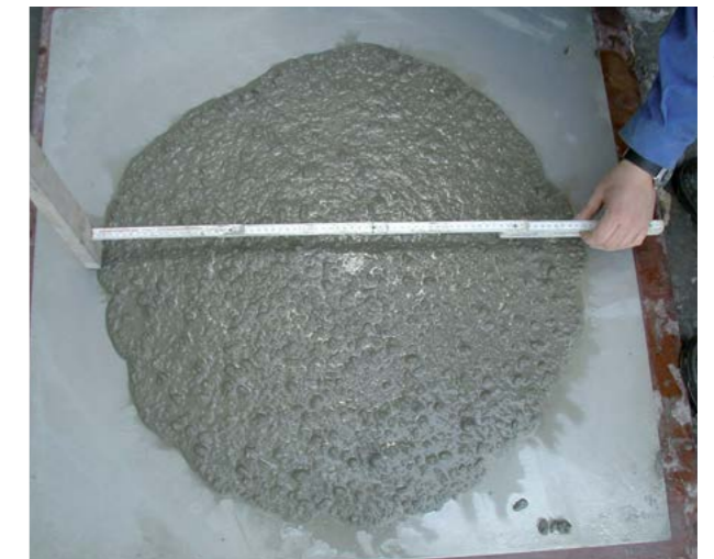
Abb. 7.4.4 Ausbreitmaß Leichtverdichtbarer Beton F6
