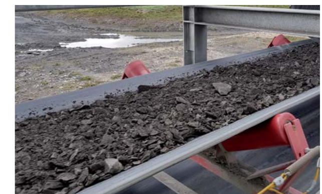
Abb. 1.6.10 Schiefer gebrochen auf dem Weg zur thermischen Aufbereitung
