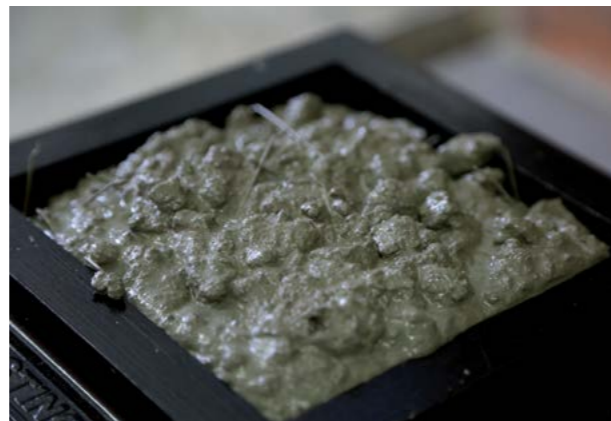
Abb. 8.16.9 Würfelherstellung mit Stahlfaserbeton
