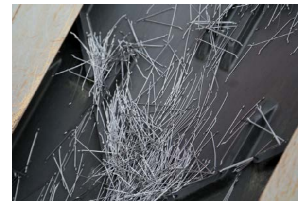
Abb. 1.7.8 Dosieren von Stahlfasern
