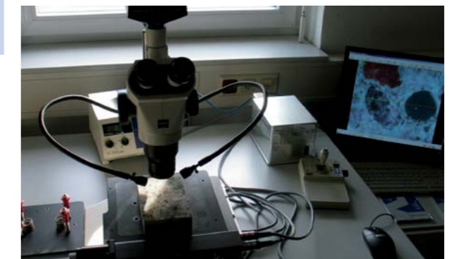
Abb. 7.2.5 Stereomikroskop mit automatischer Bildanalyse zur Ermittlung der Luftporenkennwerte am Festbeton
