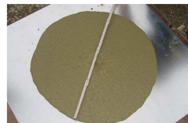
Abb. 7.6.4 Konsistenzmessung bei Leichtbeton
