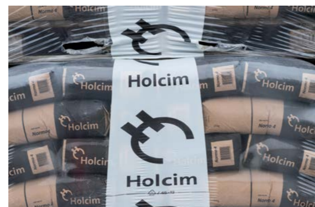
Abb. 1.1.33-2 Schrumpffolie zum Schutz von Sackzement vor Feuchtigkeit
