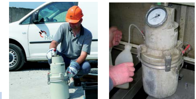
Abb. 7.2.3 und 7.2.4 Gerät zur Messung des Luftgehalts von Frischbeton (Luftporentopf)
