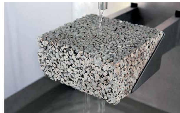
Abb. 7.11.4 Demonstration der Wasserdurchlässigkeit an einem Stein aus Dränbeton
