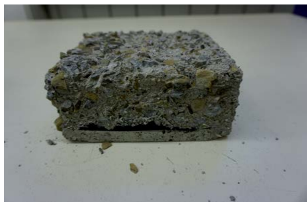
Abb. 3.2.6 (links) Prüfkörper nach 28 FTSW mit starken Abwitterungen
