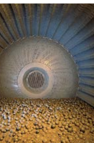
Abb. 1.1.5 Kugelmühle zum Feinmahlen des Klinkers mit Gipsstein und weiteren Hauptbestandteilen
