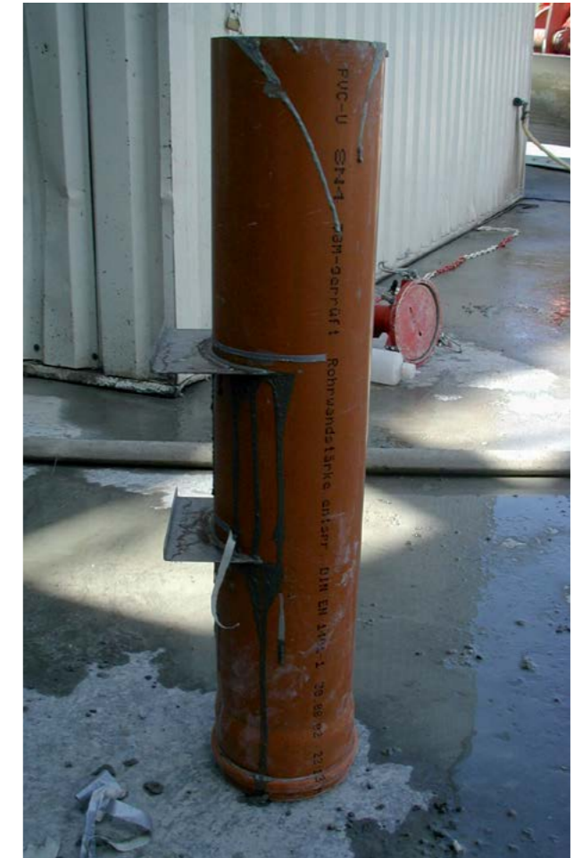
Abb. 10.1.5 Dreigeteiltes Rohr um die Entmischungsneigung zu prüfen
