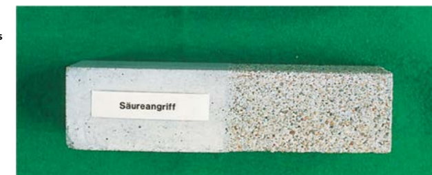
Abb. 10.5.1 Von Säure angegriffenes Zementmörtelprisma (rechte Prismenhälfte)
