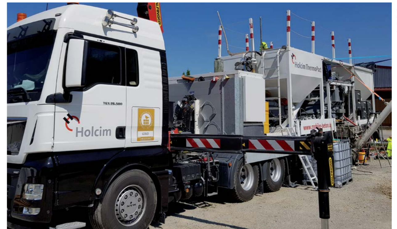
Abb. 7.14.4 Mobile Mischanlage für Infraleichtbetonanwendungen
