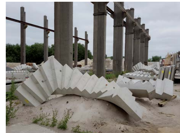
Abb. 9.1.1 Betonfertigteile (Treppen) auf dem Lagerplatz
