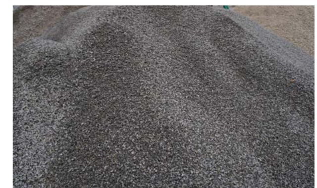
Abb. 1.3.7 Gebrochene Gesteinskörnung, Splitt
