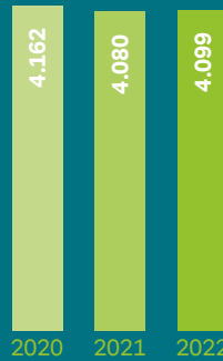
Spezifischer thermischer Energieverbrauch der Zementwerke 1 (MJ/t Klinker)
